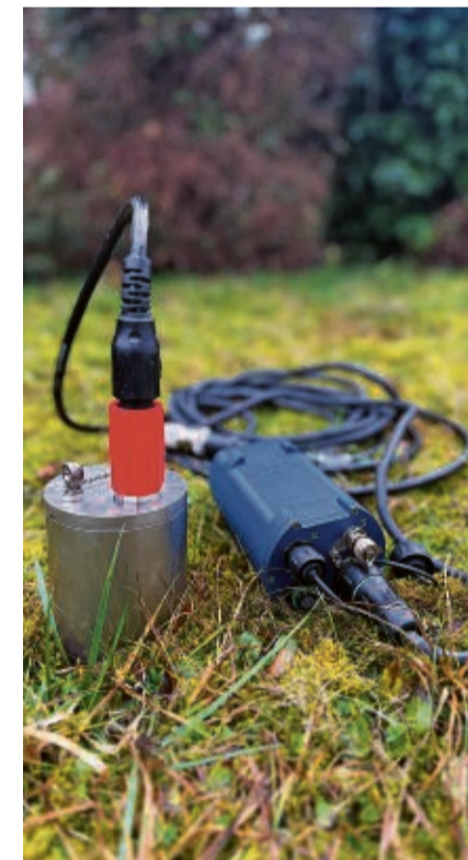
Un sismomètre avec son enregistreur de données.
