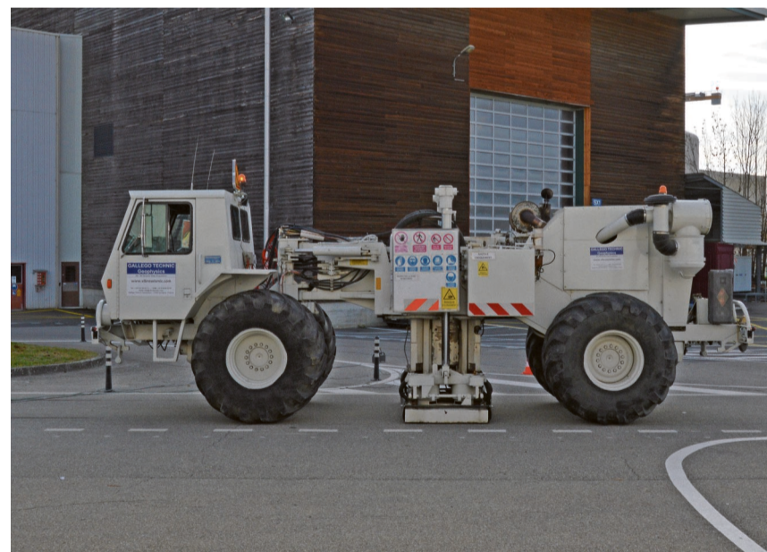
Camion vibreur de type Mark IV qui génère des ondes acoustiques dans le sol au moyen d'une plaque vibrante.
