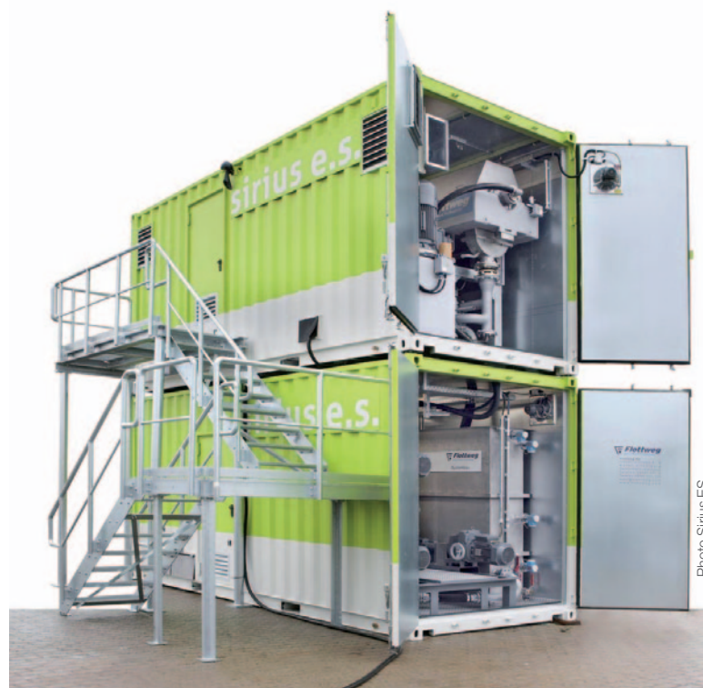
Exemple d'un système de traitement de la boue de forage comprenant centrifugeuses et unité de floculation.
